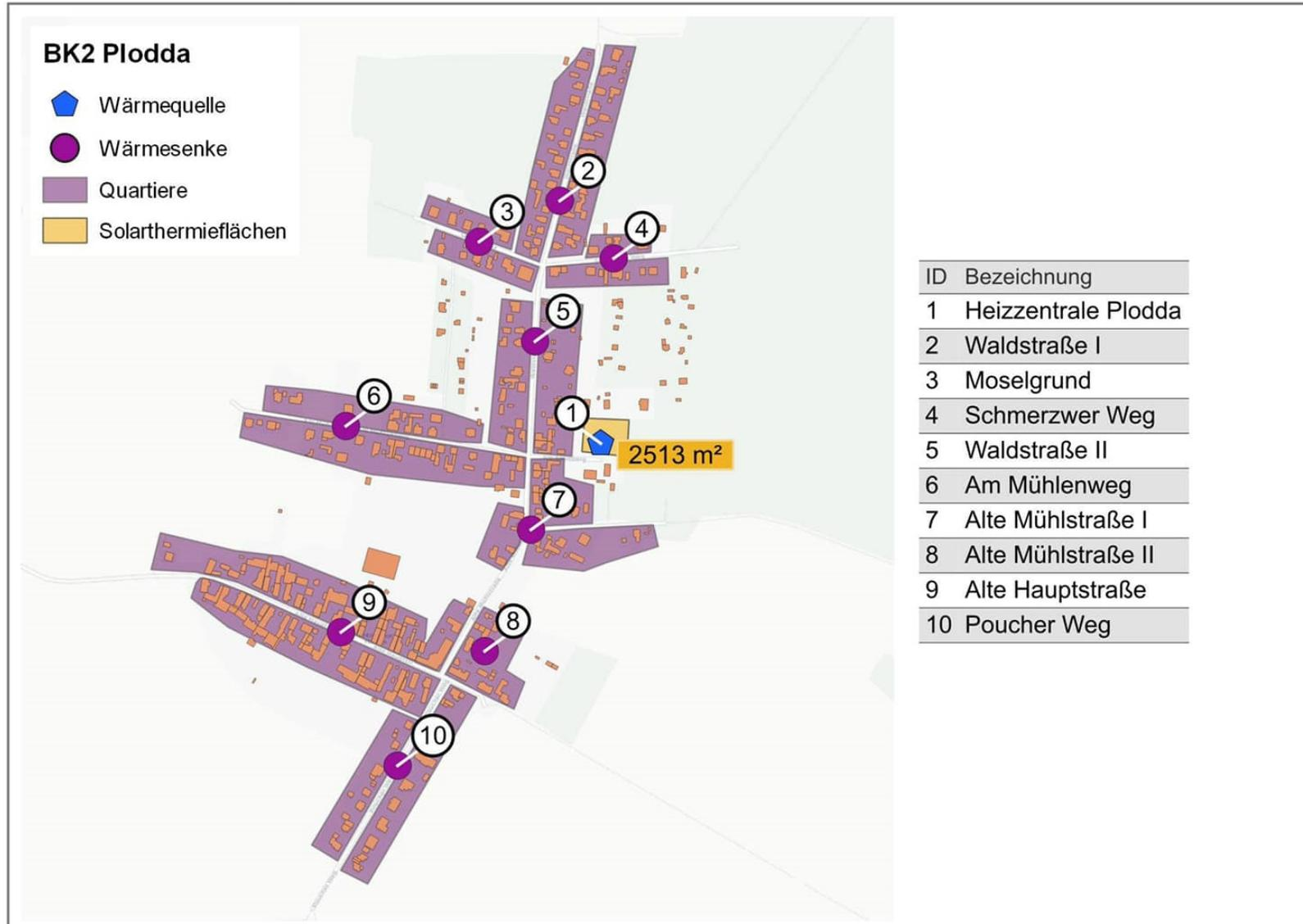
Abbildung 27 | Lageplan des Ortes Plodda mit Kennzeichnung Wärmequellen und Wärmesenken
