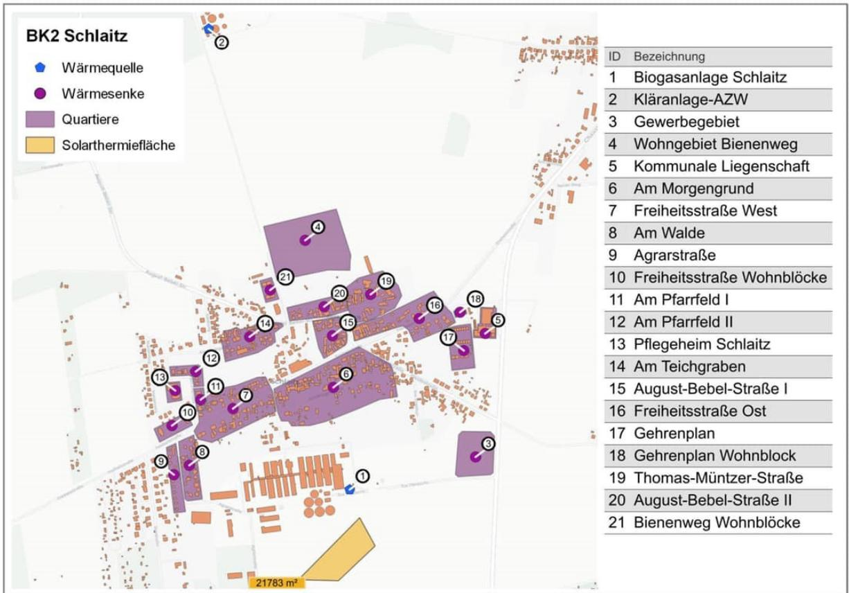
Abbildung 25 | Lageplan des Ortes Schlaitz mit Kennzeichnung Wärmequellen und Wärmesenken
